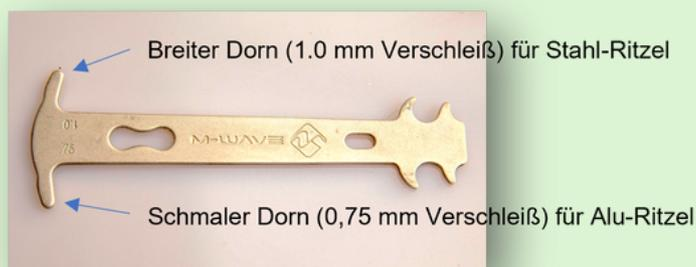
Die Handhabung ist kinderleicht. Die Lehre hat zwei Dornen, einen dicken für Stahlritzel und einen dünnen für Aluritzel. An Nabenschaltungen sind in der Regel Stahlritzel verbaut. Hier mit dem dicken Dorn messen. Bei einer Kettenschaltung bestehen die meisten Ritzel aus Alu. Hier also mit dem dünnen Dorn messen.
