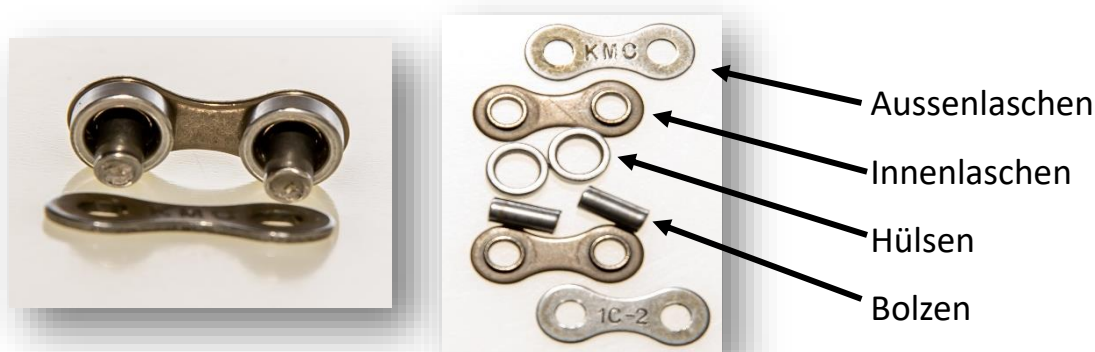
Abb: 1 Aufbau der Kettenglieder
